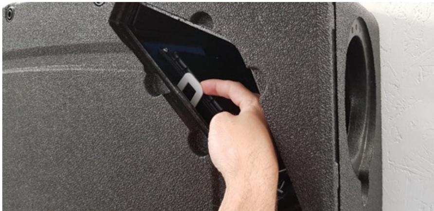
**Schritt 3 •** Ziehen Sie die Anschlussdose ein Stück heraus, damit Sie Zugang zum Sensor haben.
